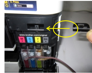
Gebruik het kleptooltje en plaats deze in de sensor-opening
