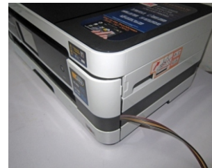
Sluit de klep en zorg dat de slangen netjes uit de printer komen
